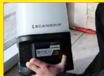
Sostituisci la batteria scarica
